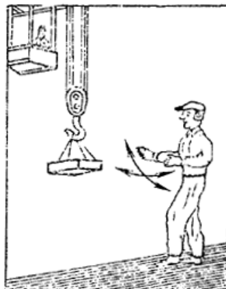
Рис. 10. Мгновенная остановка: резкое горизонтальное движение обеими руками вправо и влево на уровне пояса. Резкие частые повороты головой из стороны в сторону
