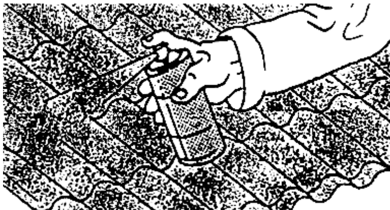
Рис.17. Окраска срезов, сколов и повреждений защитного слоя
