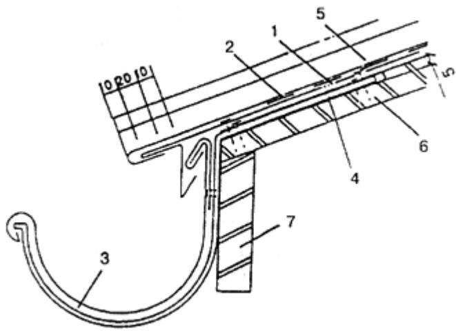
1 - карнизный свес; 2 - подстилающий слой; 3 - полуокруглый водосточный желоб;
