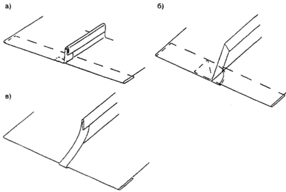
а и б - с квадратными кромками; в - со скошенными кромками
