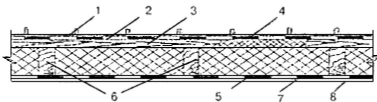
1 - фальцевая медная кровля; 2 - подстилающий слой; 3 - сплошной настил из досок хвойных пород;
