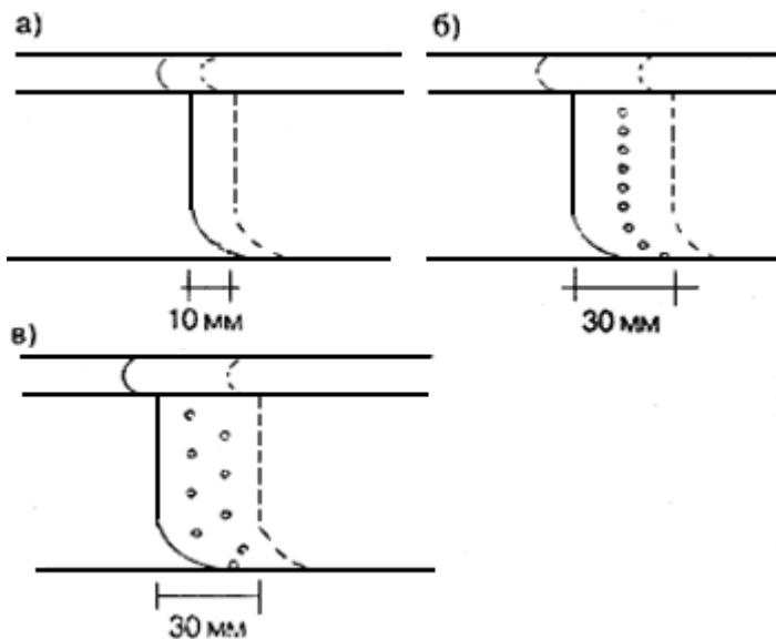
а - мягкая пайка или твердая сварка; б - мягкая сварка с одним рядом заклепок;
