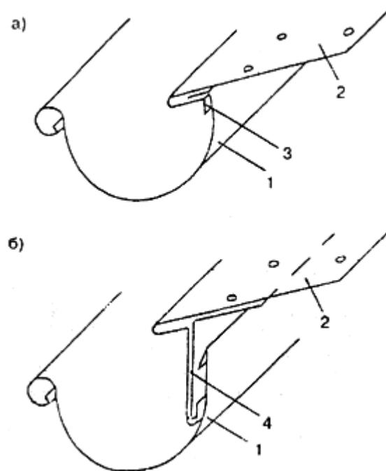
1 - полуциркульный желоб; 2 - карнизная планка; 3 - короткий вертикальный свес; 4 - длинный вертикальный свес
