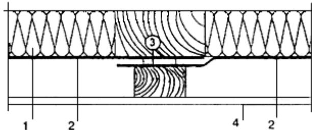
1 - теплоизоляция; 2 - пароизоляция; 3 - герметизирующая полоса; 4 - потолок (например, гипсокартон)
