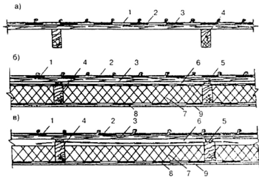
а - над холодным чердаком; б - над утепленным покрытием с одним вентиляционным каналом;
