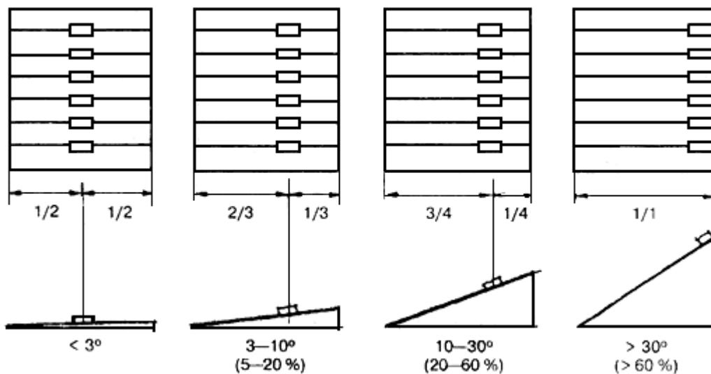
Рисунок 8 - Места установки неподвижных кляммеров на кровле с длиной ската более 3 мм\*
