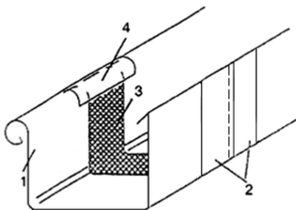
1 - желоб коробчатого сечения; 2 - две медные полосы; 3 - полоса из вулканизированного неопрена;
