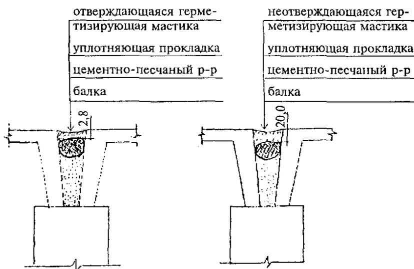
Рис. 1. Конструктивные решения герметизации швов кровельных плит
